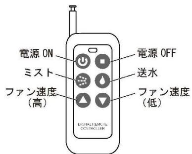
注意: 本体とリモコンは、必ずセットでご使用ください。他のリモコンで操作しても作動しません。
